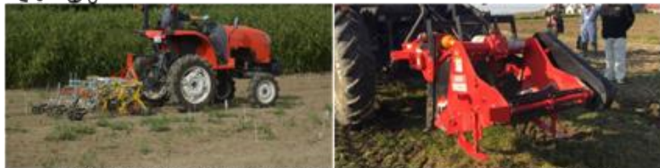
除草機(右)とカンゾウ収穫機(左 特許出願中) 農研機構と共同開発
