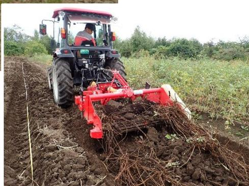
北農研試作機をベースにメーカーが製作した2畦用収穫機（村上氏提供）
